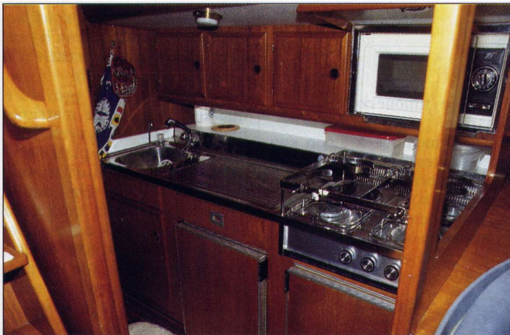
La cucina (a lato) ha piano cottura con tre fuochi a gas e piastra elettrica, lavello in acciaio e piano lavoro. Due i frigoriferi ad incasso.
